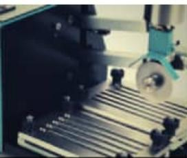
Machine pour la résistance à la coupe ( Ancienne EN388 ) - Lame rotative
