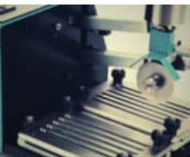
Machine pour la résistance à la coupure ( Ancienne EN388 ) - Lame rotative
