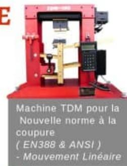
Machine TDM pour la Nouvelle norme à la coupure ( EN388 & ANSI ) - Mouvement Linéaire
